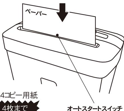
3. ペーパーを中央のオートスタートスイッチを押すようにペーパー挿入口に挿入してください。裁断後、自動的にカッターが停止します。
