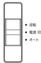
2. モード切替スイッチを【オート】モードに設定してください。ペーパーを中央のオートスタートスイッチを押すようにペーパー挿入口に挿入してください。細断後、自動的にカッターが停止します。
