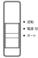
3. 終了後は必ずモード切替スイッチを【電源 切】モードに設定してください。
