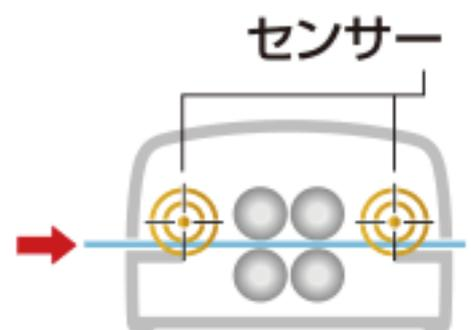
さらに PTS Plus では、自動的にローラーが逆転してフィルムを押し戻します。
