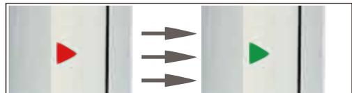
● 電源ボタンを押すとインディケータが【赤色】に点滅します。ラミネート可能な温度になると【緑色】に点灯します。
